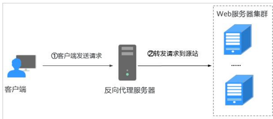
图 16-3 Nginx 转发原理
