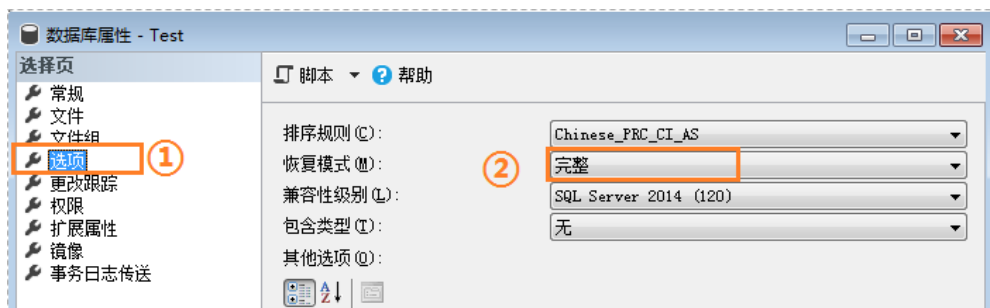
图6-13 检查数据库恢复模式
